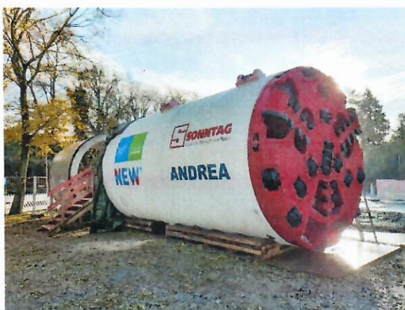
Der in Viersen eingesetzte Bohrkopf „Andrea“. Die Front des Bohrkopfs (rot) mit den Meißeln ist gut sichtbar. Quelle: Rheinischer Spiegel
